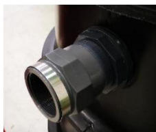
PE csőhöz előkészített adapter külső menettel (átmérő = 63 mm)
