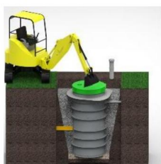
Helyezze a geotextíliát a szivattyútelep köré legalább 20 cm-rel szélesebbre.
