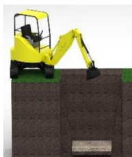
Készítsen egy 10 cm vastag homokágyazatot, és egyenlítsé ki a szintezőeszközzel.
