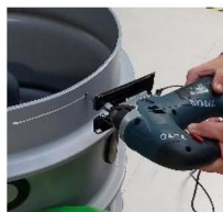
A szűrőfűrészsel vágja le a tengely felesleges magasságát
