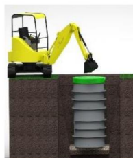
Helyezze a szivattyúállomást az építési gödörbe
