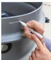
Jelöld meg a szivattyútengely megfelelő magassága
