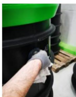
Tisztítsa meg a cső és az adapter felületét tisztítószerrel
