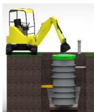
Csatlakoztassa a beömlőcsövet és készítse el a szellőzőcsövet
